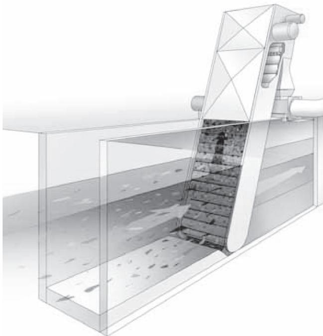
**Figura 3.1** – Schema di sezione d'impianto per la grigliatura: griglia immersa nel canale di adduzione del refluo.
