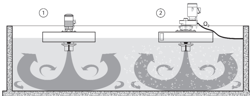
Trattamento combinato ad aerazione meccanica e ad ossigeno puro: turbina 1 con flusso liquido dalla superficie verso il fondo (miscelazione meccanica); turbina 2 con flusso di ossigeno puro dalla superficie verso il fondo (ossigenazione con ossigeno puro dall'esterno).
